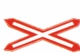
Kontrolsüz Demiryolu Geçidi (Tek Hat)
